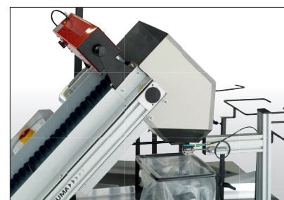
Befüllung über ein SCHUMA Förderband mit Ionisierung.
